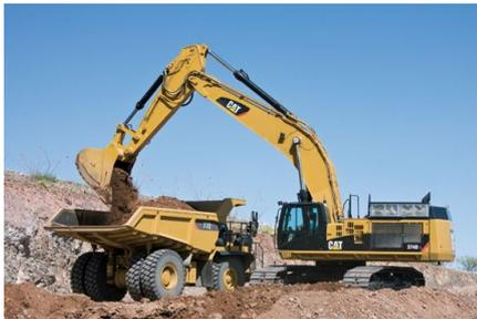
Когда ведется строительство, используются гусеничные экскаваторы с одним ковшом. Это землеройные механизмы с циклическим действием. В их оснащение входит ковш, как рабочий орган. Рабочий цикл такой машины включает в себя ряд операций выполняемых друг за другом.
