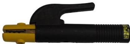
Электрододержатель разработан для крепления сварочного электрода. Он предназначен для того, чтобы по нему подводить сварочный ток и производить манипуляции при сварке. Держатель должен удовлетворять ряду требований. Он должен обеспечивать надежный электроконтакт, иметь небольшую массу и давать возможность работать без серьезных усилий. Электрододержатель также должен надежно крепить электрод в разных положениях. Тогда не будет изгиба при работе в труднодоступном месте.
